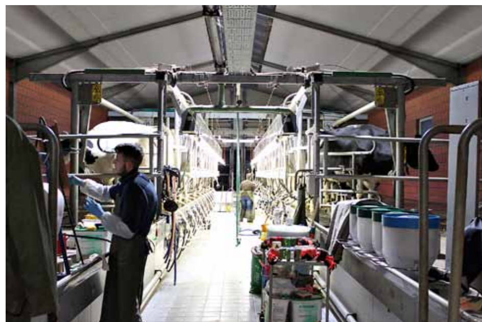
TO GANGER PER DAG: Den doble fiskebeinsstallen har til sammen fjorten plasser, og kyrne melkes to ganger om dagen. Hele operasjonen tar to og en halv time, der to ansatte setter på melkeorgan og én styrer kuttrafikken.
