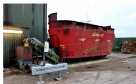
FØRING: Drecker omtaler bare biogassanlegget for en kjempestor kumage. Og inn i biogassanlegget går det omtrent de samme planteråvarene som inn i en kumage, til og med utstyret er det samme. I denne fullfôrblenderen går det 110 tonn plantemateriale hver dag.
